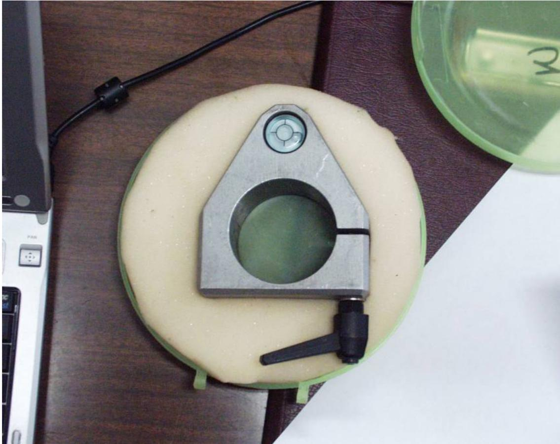
**Fig. 14: livella sferica da applicare al corpo A del monumento per una prima messa in bolla grezza.**
