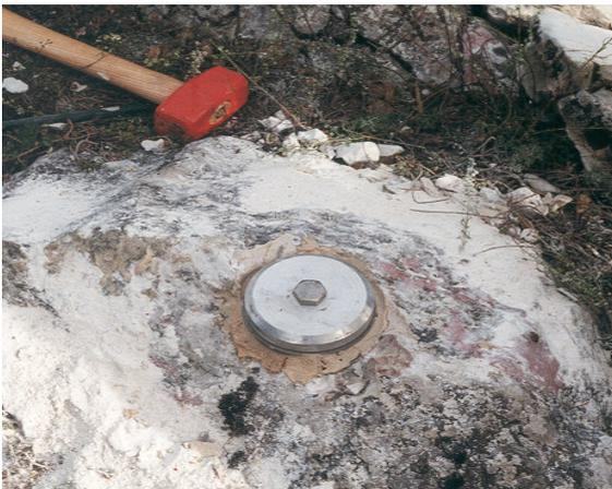
Fig. 9: caposaldo fissato sulla roccia con tappo di chiusura fissato in testa.
