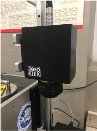
Il sensore Geoscan V camera system è un modulo aggiuntivo del Multi Sensor Core Logger (MSCL) che permette l'acquisizione di immagini ad alta definizione e valori RGB di carotaggi, che poi possono essere correlate con i dati delle proprietà fisiche (densità, velocità delle onde P e suscettività magnetica) acquisite tramite MSCL.
