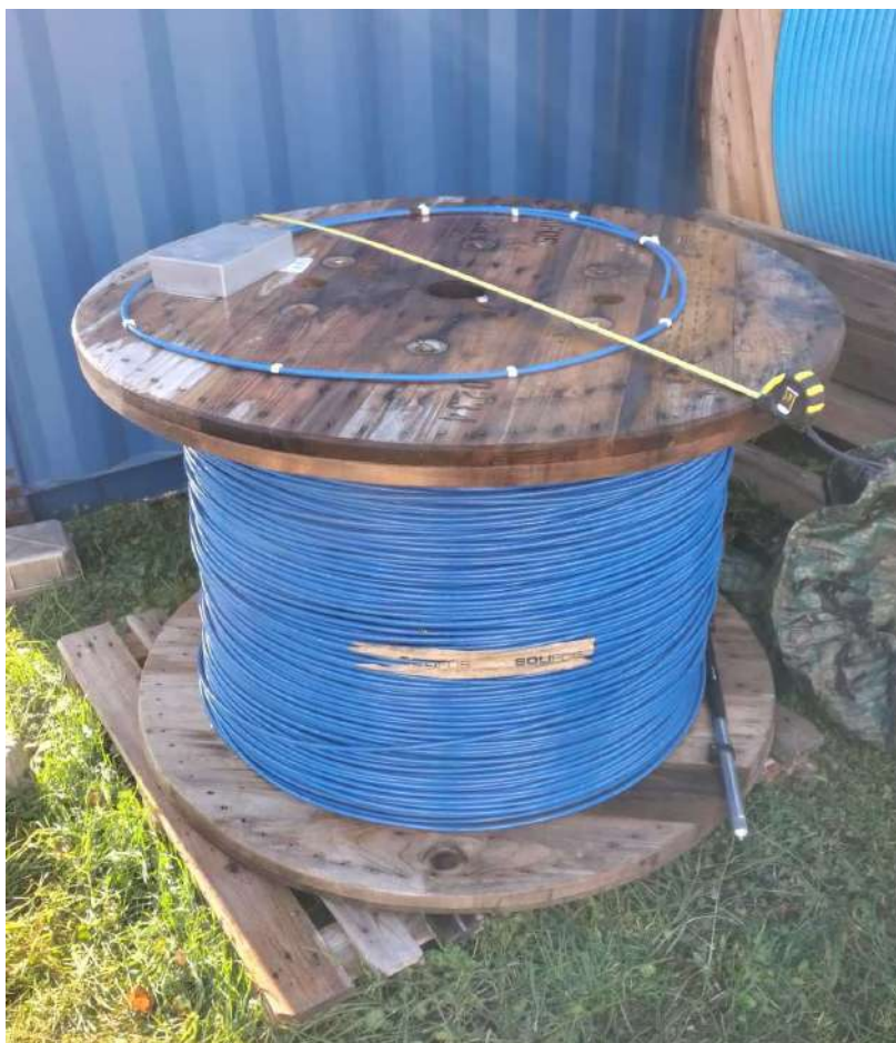
Figura 5 – Cavo DAS montato su rullo in legno con terminazioni
